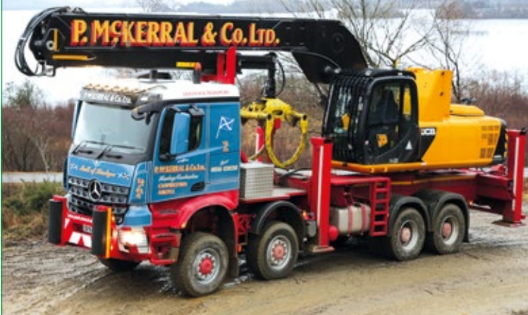
Поворотная платформа JCB JS220 на колесном шасси грузовика Mercedes Atros 8x8
